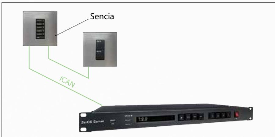
Solution de commande déportée du ZerOS Serveur via panneaux de contrôle muraux sur protocole iCAN
