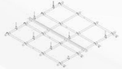
**AD/GRID\_SYSTEM** - Système de construction de grill tubulaire
